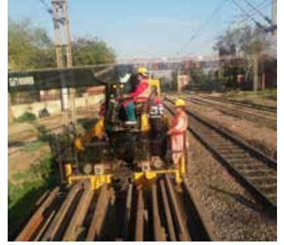
यूटीवी रेलपथ मशीन को रेल स्लीपरों जैसे भारी रेलपथ सामग्रियों को उठाने एवं एकात्रित करने के लिए उपयोग किया जाता है
